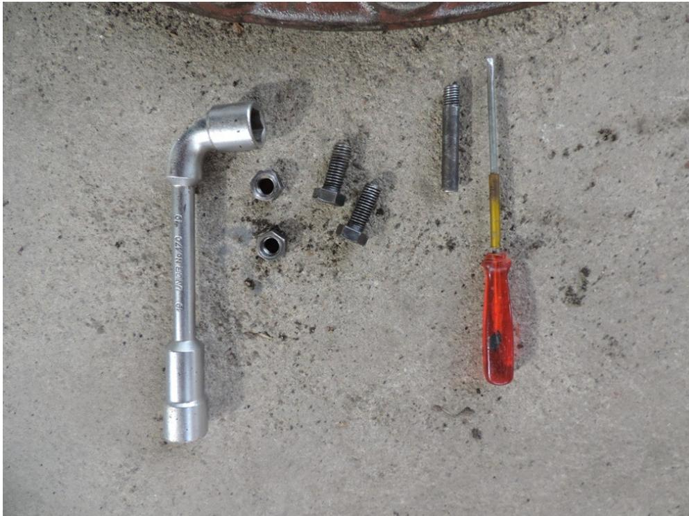
2 écrous, 2 vis, Une clé de 19mm, un tournevis plat et la clavette.
