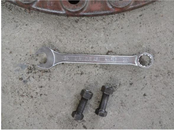
Une clé de 24mm et les 2 boulons (boulon= vis+écrou).
